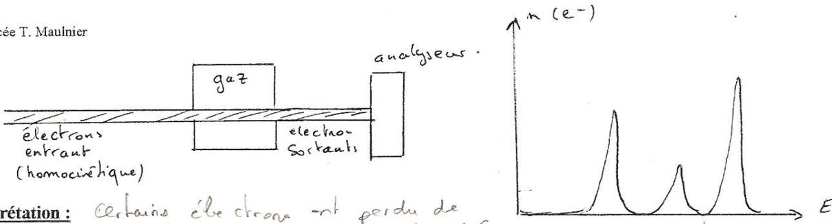
**Interprétation :** Certains électrons ont perdu de l'énergie après sortie du gaz, les pertes d'énergie ne prennent que certaines valeurs bien distinctes. Lorsque un faisceau d'électrons est en interaction avec des atomes d'un gaz, les **quantités d'énergie** cédées par les électrons aux atomes ont des valeurs discrètes.
