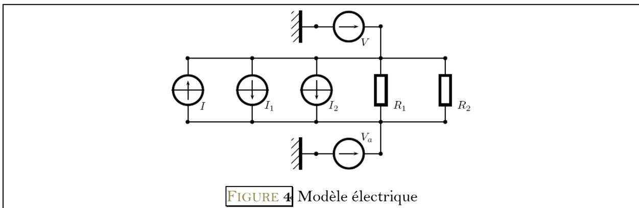
On écrit la loi des nœuds et on obtient :  $\frac{V-V_a}{R_1} + \frac{V-V_a}{R_2} + I_1 + I_2 = I$ . Le montage électrique proposé n'est pas satisfaisant, il correspond à la situation étudiée sur le plan thermique uniquement si les générateurs ne débitent pas de courant. L'image proposée n'est pas bonne.
