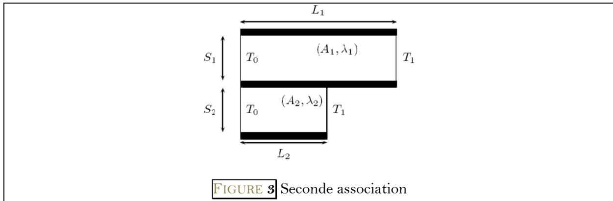
On constate que les deux corps étudiés sont soumis à la même différence de température. Cette situation est analogue de celle en électricité où deux dipôles sont soumis à la même tension. Ils sont donc montés en parallèle. La résistance thermique équivalente aux deux résistances est donc :  $R_{th} = \frac{R_{th1}R_{th2}}{R_{th1}+R_{th2}}$ .
