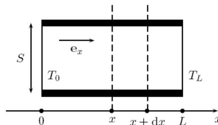
FIGURE 1 Conducteur thermique
