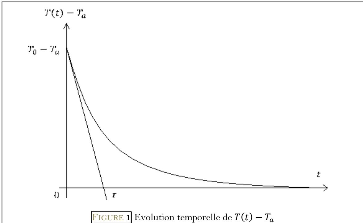
Graphiquement (**FIGURE 1**), la courbe concorde avec ce à quoi on peut s'attendre, la température de la plaque décroît pour s'uniformiser avec la température de l'air ambiant et des parois de la pièce.
